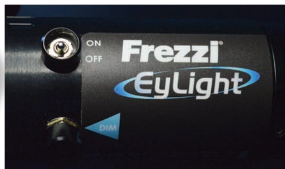
Органы управления – выключатель и регулятор диммера
