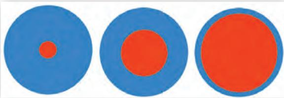
Рис. 4. Оптические волокна разного диаметра (слева направо): 9/125, 50/125 и 105/125 мкм
