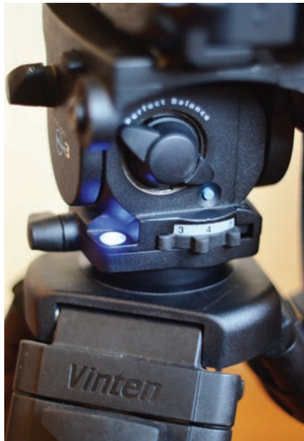
Тыльная сторона головки: уровень, регуляторы контрбаланса и горизонтального панорамирования
