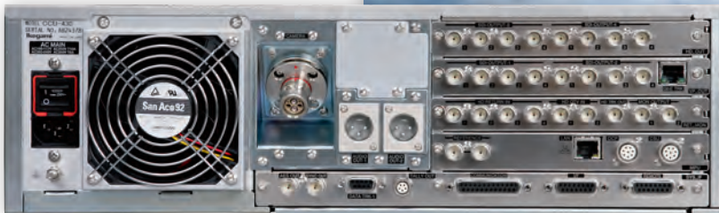
Базовая станция Ikegami CCU-430 – вид со стороны панели разъемов
