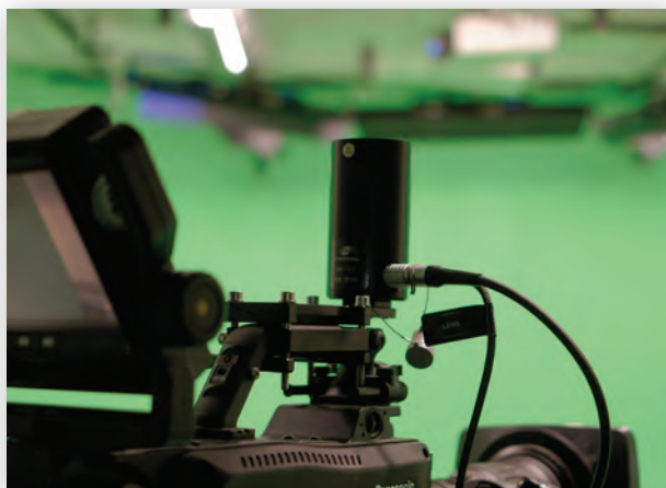
Датчик системы трекинга на камере
