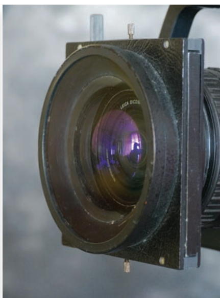
Фильтродержатель с фильтрами и широкоугольной линзой
