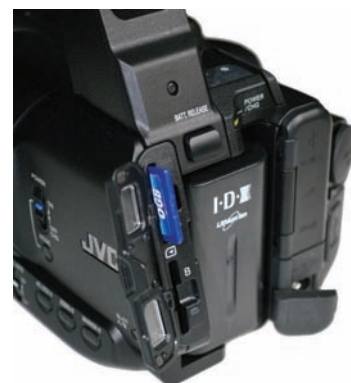
Вид на камеру со стороны батарейного отсека и слотов для карт памяти
