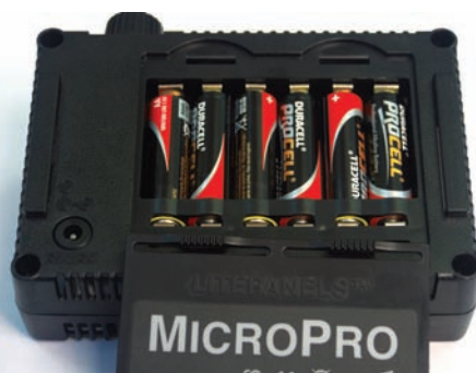
Прибор с открытым батарейным отсеком. В левом нижнем углу виден разъем для подключения внешнего источника питания
