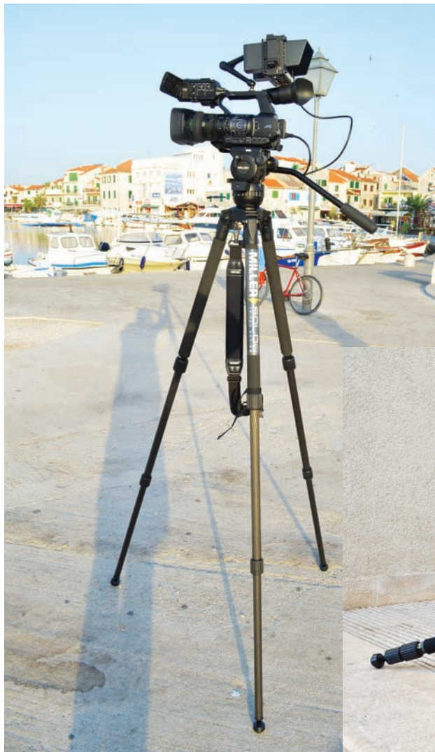
Штатив Compass 12 с установленным на нем оборудованием – ножки выставлены на максимальную длину
