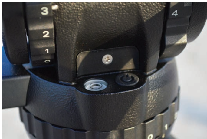
Жидкостный индикатор уровня и кольца управления контрбалансом и демпфированием по обеим сторонам головки
