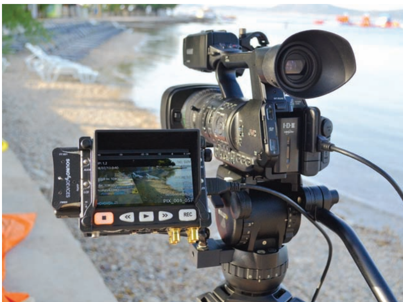
Установка рекордера на дополнительную площадку с помощью специальной сочлененной руки
