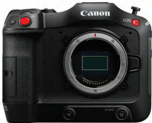
CEOS со снятым объективом – вид на сенсор
