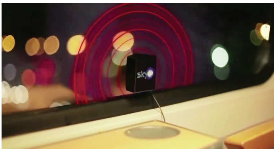
Передатчик, заставляющий стекло вибрировать
