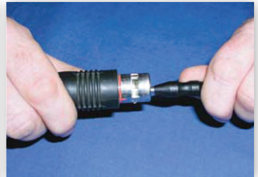
Рис. 9. Установка колец в разъем
