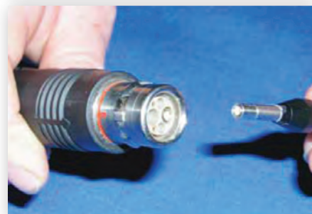
Рис. 4. Снятие центрующих колец оптических контактов
