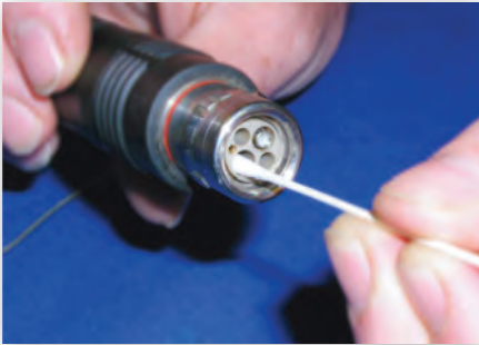
Рис. 6. Процесс чистки разъема вручную
